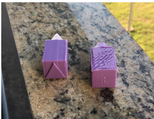
Figura 2. Modelos iniciais das peças feitos na impressora 3D. (Peça da esquerda: com identificação em formas geométricas; da direita: com identificação em braille).
